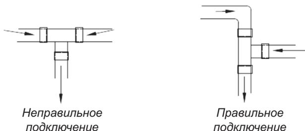
При подключении дренажной трубки к блоку, зафиксируйте ее с помощью хомута. В целях обеспечения простоты обслуживания и ремонта не используйте клей для крепления трубы. Вертикальный участок линии всасывания дренажного насоса должен составлять 200–500 мм. Убедитесь, что уклон дренажной трубы не менее 1%. Расстояние между опорами дренажной трубы — 1000–1500 мм.
