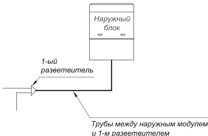
Если в системе несколько наружных блоков объединено в один модуль, диаметр труб между последним тройником ML и первым разветвителем FQ определяется в зависимости от суммарной производительности наружных блоков.
