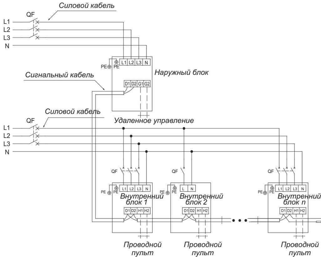
Несколько наружных блоков в системе (модульная компоновка):
