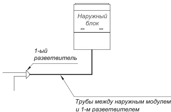
Если в системе несколько наружных блоков объединено в один модуль, диаметр труб между наружным блоком и ближайшим тройником соответствует размеру патрубков на наружном блоке.
