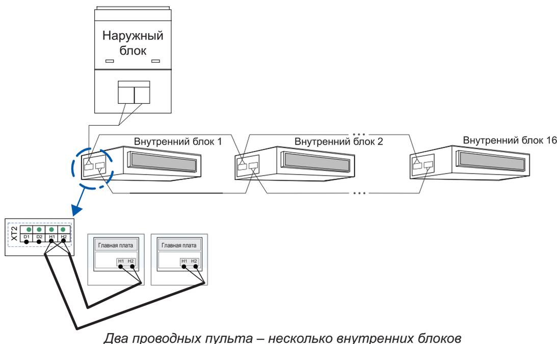
Когда два проводных пульта управляют одновременно несколькими внутренними блоками, проводной пульт может подключаться к любому из них, но все подключенные блоки должны быть из одной серии. Один из пультов должен быть назначен вспомогательным. Общее количество внутренних блоков, управляемых с одного проводного пульта, не должно превышать 16, и подключенные блоки должны принадлежать к одной рабочей сети.
