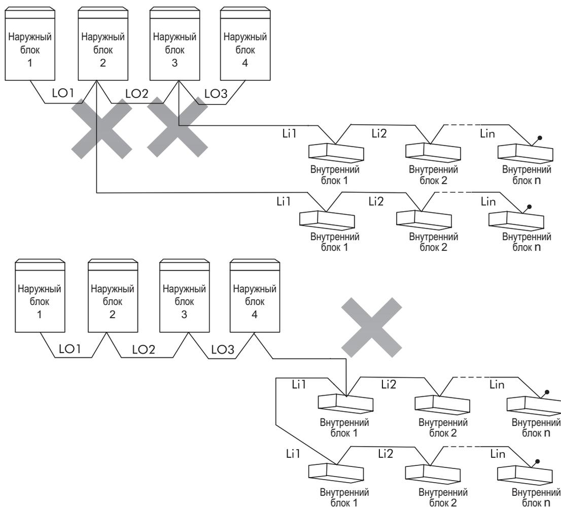
Межблочный кабель подключается к клеммам D1/D2 на клеммной панели XT2.
