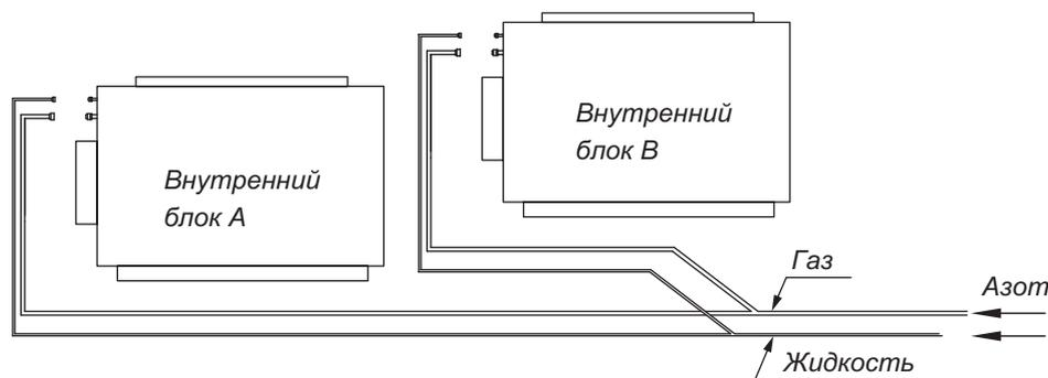
**Шаг 2:** Установите насадку на жидкостную трубу системы и подсоедините к ней шланг высокого давления манометрического коллектора, установленного на резервуар с азотом.
