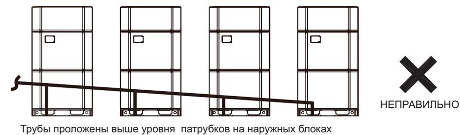
Перепад высот и длина трубопроводов между наружными блоками имеют ограничения. Если расстояние  $A+B$  между наружными блоками превышает 2 м, в газовой линии низкого давления необходимо установить U-образную масляную петлю на расстоянии не больше 2 м от разветвителя ML.  $A+B \leq 10$  м. Перепад высот между наружными блоками не допускается.
