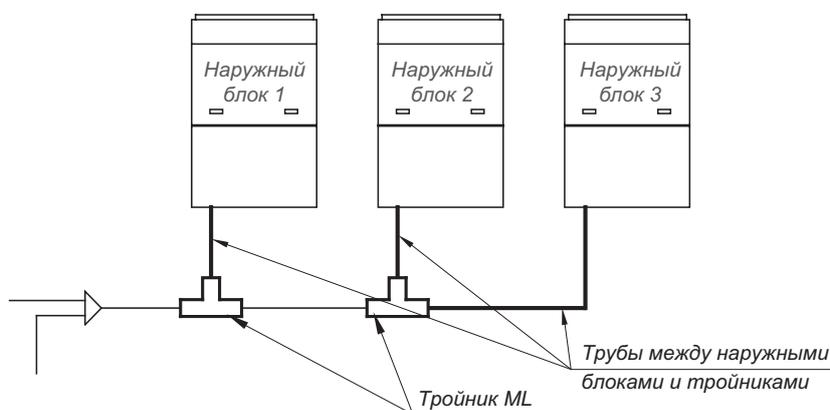
Тройники ML подбираются в соответствии с диаметрами подключаемых к ним труб. Геометрические параметры разветвителей приведены в ПРИЛОЖЕНИИ В.
