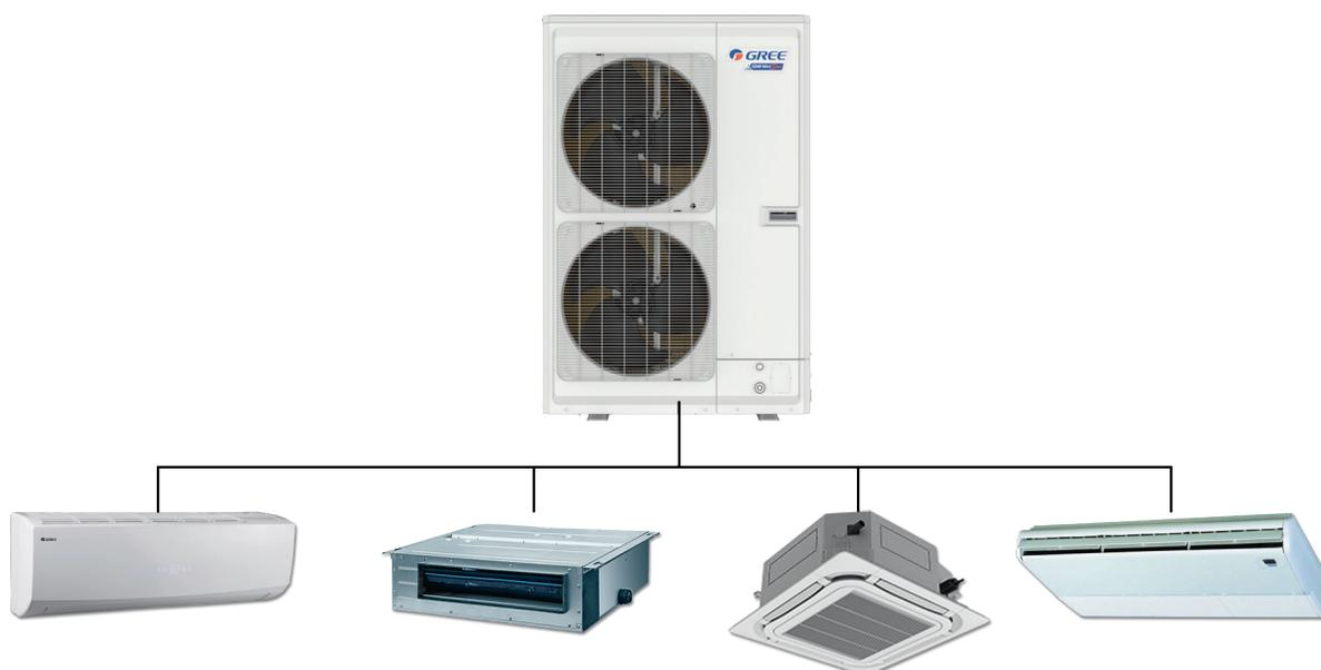
К одному наружному блоку может быть подключено не более 10 внутренних блоков. Суммарная номинальная мощность внутренних блоков должна быть в пределах 50–135% от номинальной мощности наружного блока.
