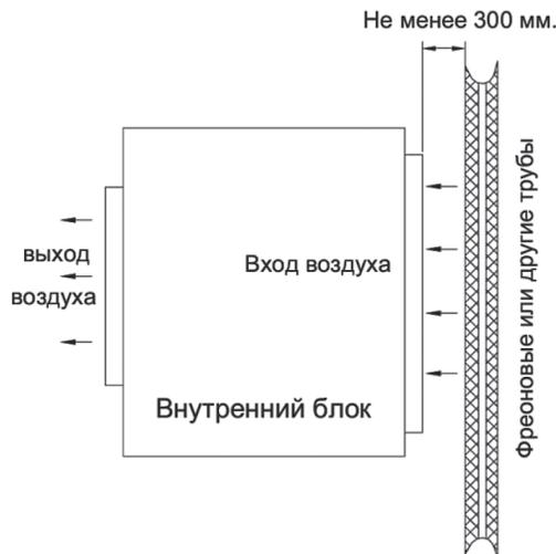
Если фреоновые трубы требуется проложить со стороны выхода воздуха из блока, не рекомендуется располагать их непосредственно напротив воздуховыпускной решетки. Фреоновые трубы не должны касаться никаких элементов внутренних блоков за исключением мест соединения. Нарушение перечисленных правил может привести к снижению производительности и повышенному шуму.
