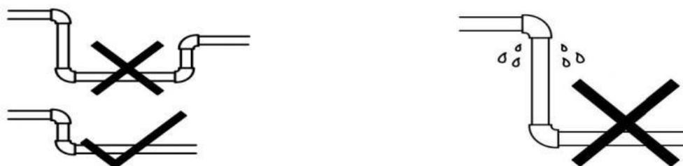
5. Если насос будет использоваться для перекачивания жидкости из водоемов, то на входном трубопроводе необходимо установить обратный клапан и фильтр. Обратный клапан необходимо располагать вертикально на расстоянии не менее 50 см от дна, для предотвращения всасывания донных отложений, песка и глины (смотрите рисунки ниже).
