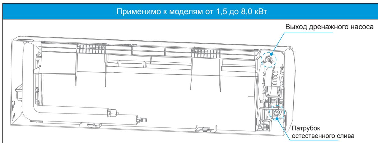
В модели без дренажного насоса выпускной патрубок при отгрузке с завода-изготовителя соединен с выпуском для естественного слива; в модели с дренажным насосом выпускной патрубок при отгрузке с завода соединен с выпуском дренажного насоса, а отверстие естественного слива закрыто сливной пробкой. Модель с дренажным насосом нуждается в настройке.
