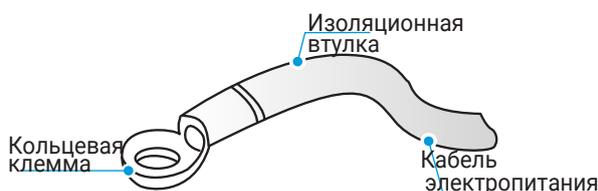
Если нет возможности обжать кольцевые клеммы из-за ограниченного пространства на месте, необходимо подсоединить кабели электропитания с одинаковым сечением жилы с обеих сторон клеммы питания внутреннего блока (см. рис. ниже).
