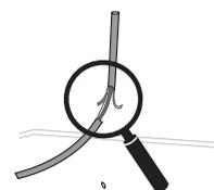
Место проведения работ следует проверить с помощью соответствующего детектора утечек хладагента, технический персонал должен быть осведомлен о присутствии потенциально легковоспламеняющейся среде.
