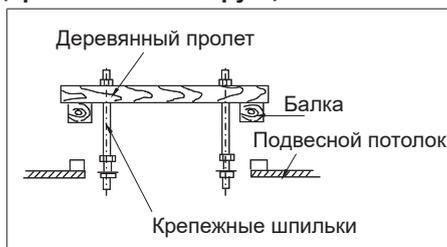
Используйте прямоугольные поперечные балки для крепления шпилек.
