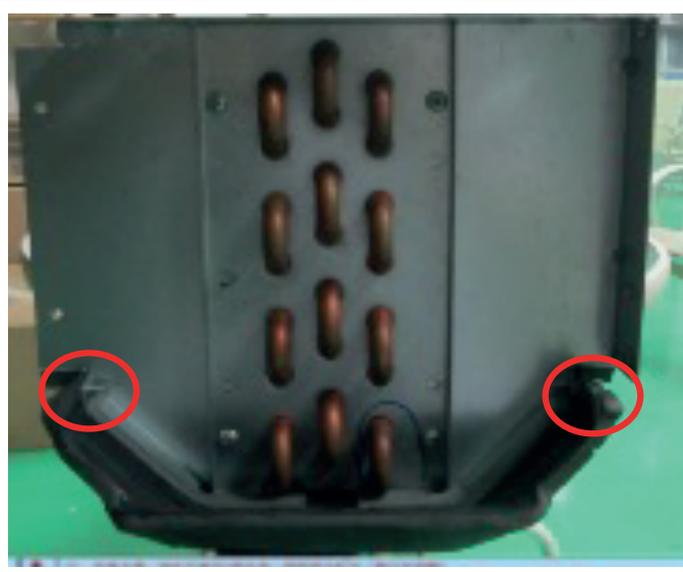
Снимите винты крепления теплообменника
