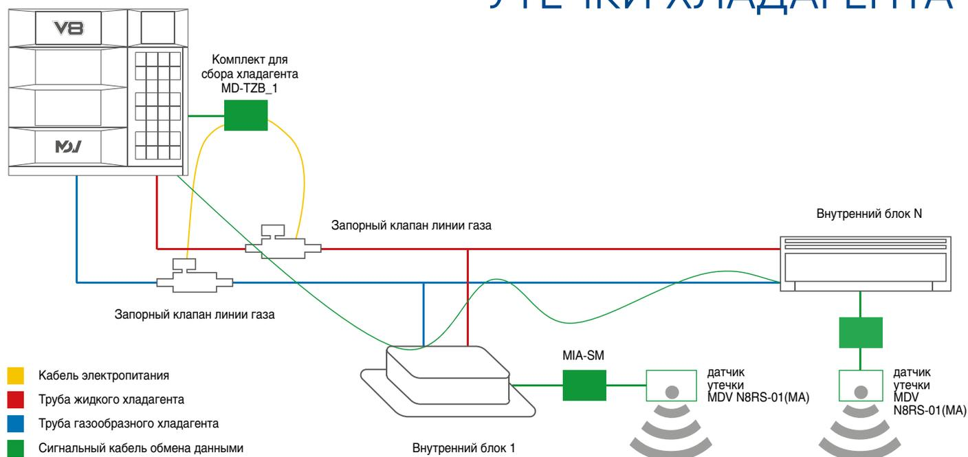
Система обнаружения и блокировки утечки хладагента MDV в режиме реального времени обеспечивает мониторинг утечки во всех помещениях, которые обслуживает VRF-система, и обеспечивает оперативный сбор хладагента в наружный блок, исключая таким образом превышение предельно допустимых значений фреона в помещениях.
