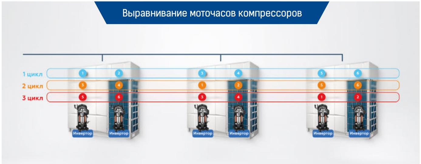
В системе VRF серии V8 автоматически действует программа выравнивания моточасов не только для компрессоров внутри одного наружного блока, но и для наружных блоков внутри одной системы, что обеспечивает стабильную работу оборудования и долгий срок службы. В блоках индивидуального исполнения VRF-систем серии V8-i выравнивание моточасов работает только в наружных блоках с двумя компрессорами.
