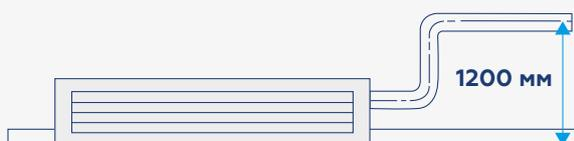
В стандартную комплектацию внутренних блоков серии V8 канального, кассетного и настенного типов входит встроенная дренажная помпа с высотой подъема конденсата до 1200 мм.
