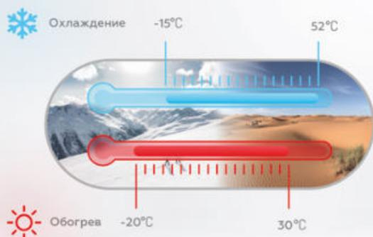
Диапазон рабочих температур VRF-системы серии V8 составляет от -15 до +52°C в режиме охлаждения и от -20 до +30°C в режиме обогрева.
