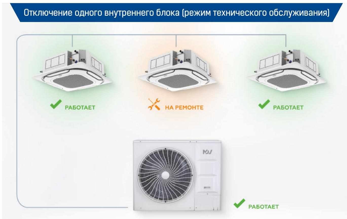
HyperLink обеспечивает не только межблочную связь, но и управляющее напряжение 24В. Это позволяет управлять ЭРВ внутреннего блока, даже если он находится без питания.
