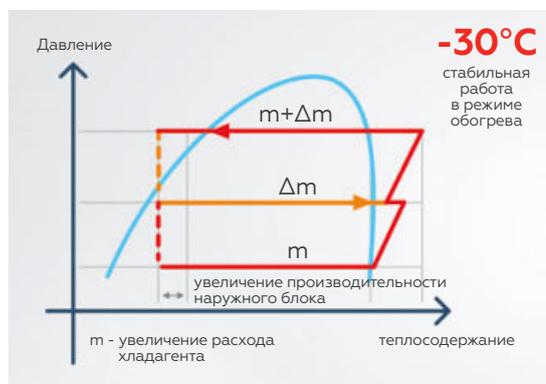
Компрессоры оснащены впрыском пара хладагента (Enhanced Vapor Injection, EVI), что позволяет системе стабильно работать в широком диапазоне температур наружного воздуха: от  $-15^{\circ}\text{C}$  до  $+55^{\circ}\text{C}$  в режиме охлаждения, а в режиме нагрева от  $-30^{\circ}\text{C}$  до  $+30^{\circ}\text{C}$ .
