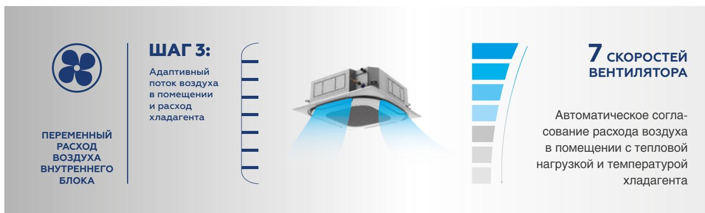
Каждый внутренний блок автоматически регулирует скорость вращения вентилятора и расход хладагента в зависимости от температуры испарения/конденсации, что обеспечивает точный контроль температуры.
