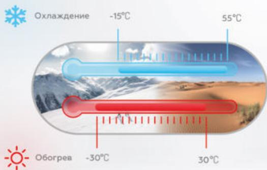
Диапазон рабочих температур VRF-системы серии V8 составляет от -15 до +55°C в режиме охлаждения и от -30 до +30°C в режиме обогрева, что обеспечивает круглогодичную работу.
