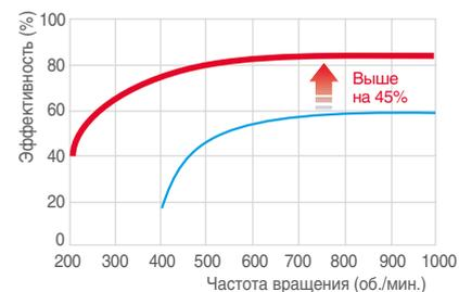
— DC-инверторный двигатель вентилятора — Двигатель вентилятора переменного тока
