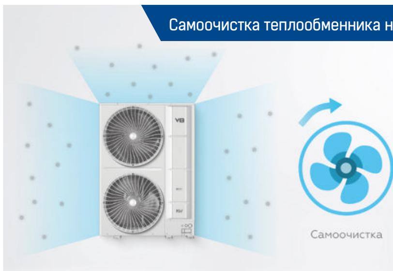
Наружные блоки VRF-системы серии V8 оснащены функцией самоочистки. После каждого полного выключения системы активируется функция самоочистки наружного блока: в течение 60 секунд вентилятор вращается в обратном направлении, продувая таким образом теплообменник и очищая его от загрязнений (например, пыли и пуха). Это позволяет улучшить теплообмен и увеличить срок службы оборудования. Функция требует активации на плате управления наружного блока.
