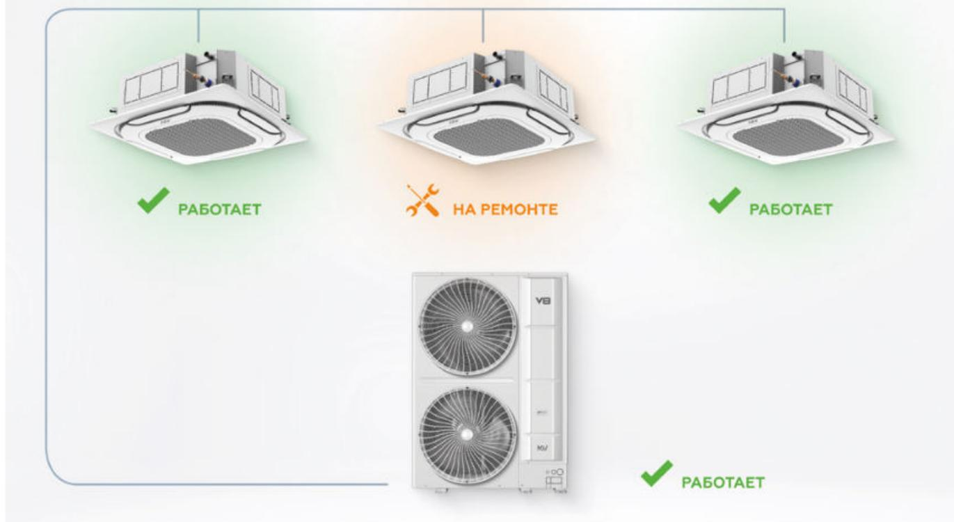
HyperLink обеспечивает не только межблочную связь, но и управляющее напряжение 24В. Это позволяет управлять ЭРВ внутреннего блока, даже если он находится без питания.
