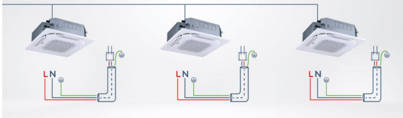
HyperLink позволяет сохранять работоспособность системы при отключении электропитания отдельных блоков. При установке VRF-системы V8 в жилых комплексах, владельцы квартир могут подключить внутренний блок к автомату, установленному в индивидуальном электрическом щитке квартиры. В случае выключения автомата, VRF-система продолжит свою работу в стандартном режиме.
