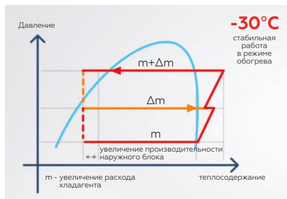
Применение компрессоров всемирно известного концерна HITACHI и дополнительный входной контроль качества позволили добиться непревзойденной надежности системы V8. Компрессоры HITACHI оснащены функцией впрыска пара хладагента (Enhanced Vapor Injection, EVI), что позволяет системе стабильно работать в широком диапазоне температур наружного воздуха: от  $-15$  до  $+55$  °C в режиме охлаждения, а в режиме нагрева от  $-30$ °C до  $+30$ °C.
