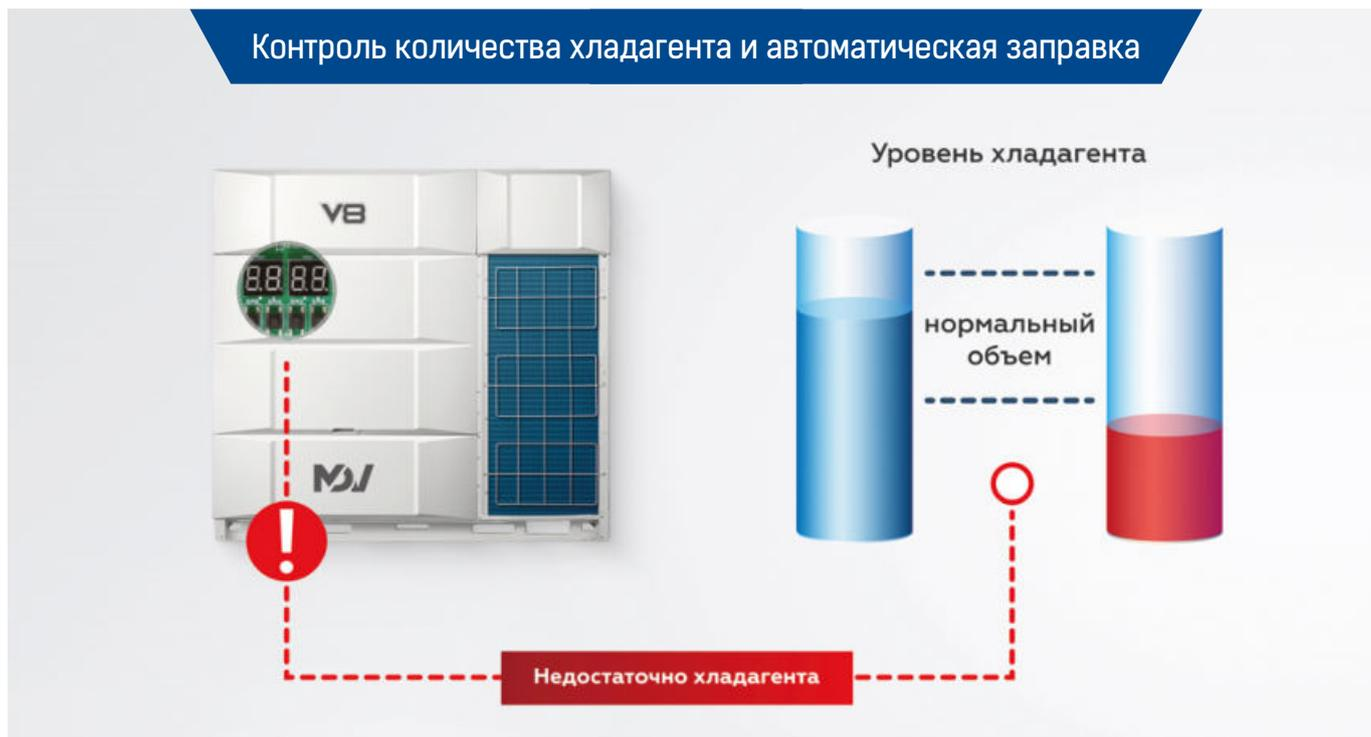
Система может контролировать количество заправленного хладагента. Функция автоматической заправки позволяет внешнему блоку определить текущее количество хладагента в системе, рассчитать необходимую дозаправку и самостоятельно управлять процессом заправки.
