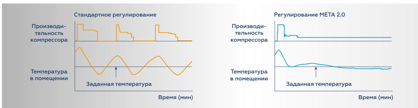
Производительность компрессора регулируется в зависимости от разницы текущей и заданной температур в каждом помещении.
