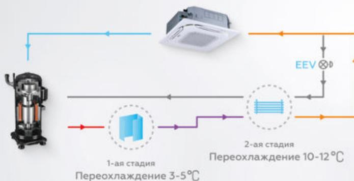
В VRF-системе серии V8 используется микроканальный теплообменник для переохлаждения хладагента, переохлаждение может достигать 15°C, что еще больше повышает холодопроизводительность и энергоэффективность, при одновременном снижении уровня шума.
