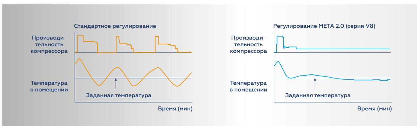
В VRF-системе MDV серии V8 производительность регулируется в зависимости от разницы текущей и заданной температур в каждом помещении, а не от суммы индексов внутренних блоков, что позволяет сделать работу всей системы более равномерной и комфортной.
