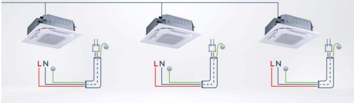
HyperLink обеспечивает возможность подавать питание на внутренние блоки от отдельных источников питания. При установке VRF-системы V8 в жилых комплексах, владельцы квартир могут подключить внутренний блок к автомату, установленному в индивидуальном электрическом щитке квартиры. В случае выключения автомата, VRF-система продолжит свою работу в стандартном режиме.
