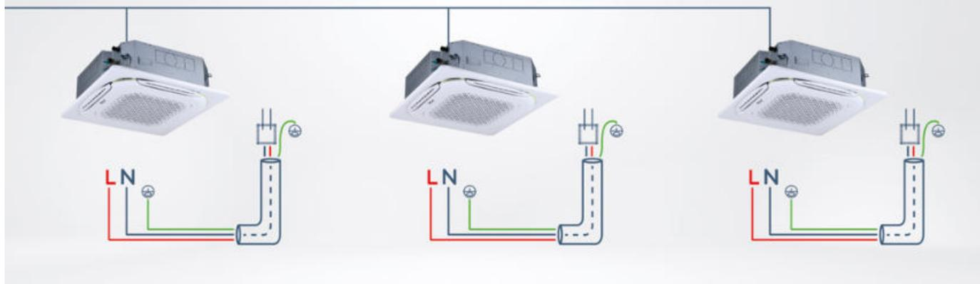
HyperLink позволяет сохранять работоспособность системы при отключении электропитания отдельных блоков. При установке VRF-системы V8 в жилых комплексах, владельцы квартир могут подключить внутренний блок к автомату, установленному в индивидуальном электрическом щитке квартиры. В случае выключения автомата, VRF-система продолжит свою работу в стандартном режиме.
