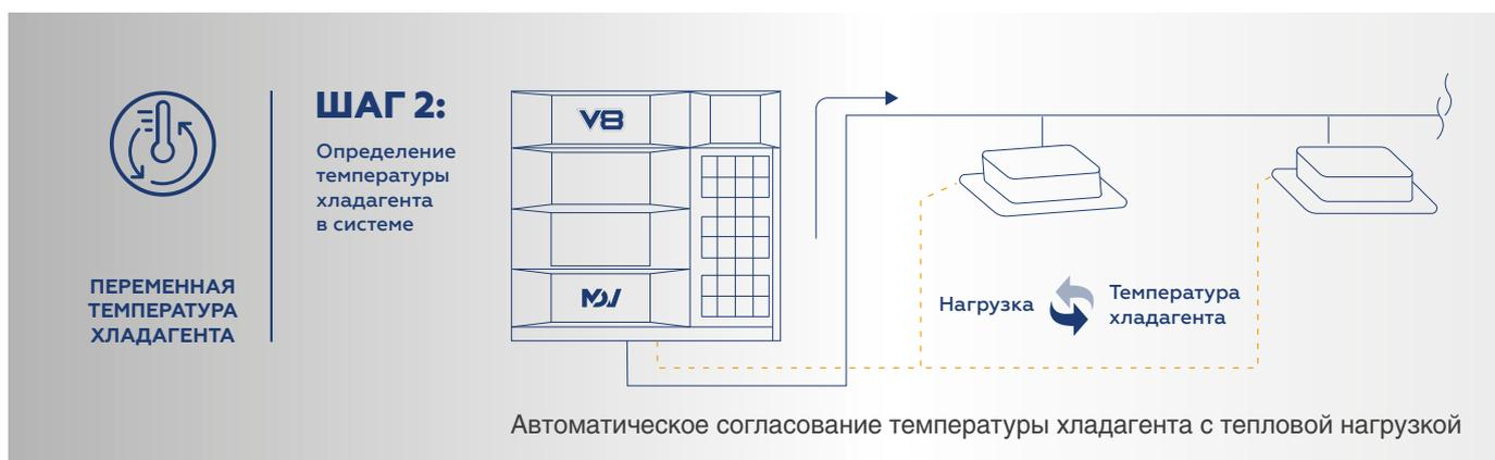
Система автоматически согласует температуру испарения (при охлаждении) или конденсации (при обогреве) с нагрузкой на помещение, что обеспечивает максимальный комфорт и энергоэффективность.
