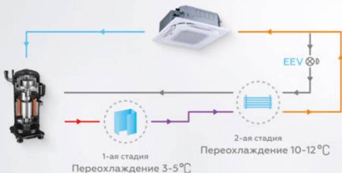
В VRF-системе серии V8 используется микроканальный теплообменник для переохлаждения хладагента, переохлаждение может достигать 15°C, что еще больше повышает холодопроизводительность и энергоэффективность при одновременном снижении уровня шума.
