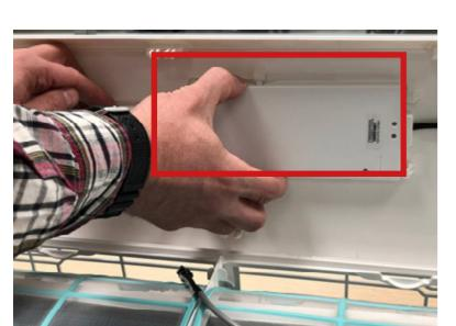
**4.** В средней части корпуса дисплея нажмите на язычок, потяните вниз и освободите средний верхний язычок защелки. Потяните его на себя и вверх.
