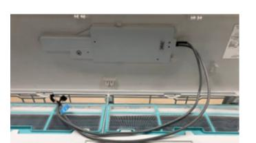
**8.** Застегните модуль дисплея на верхней панели, закрепите его винтом.
