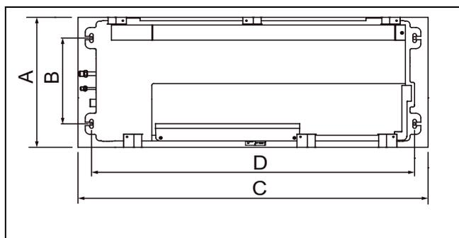
Рис. 8 Монтажная пластина
