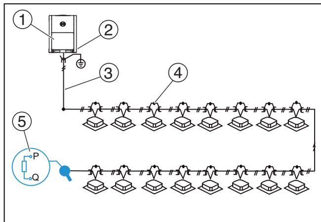
Рис. 42 Коммуникационная проводка внутренних и наружного блоков (PQE)
