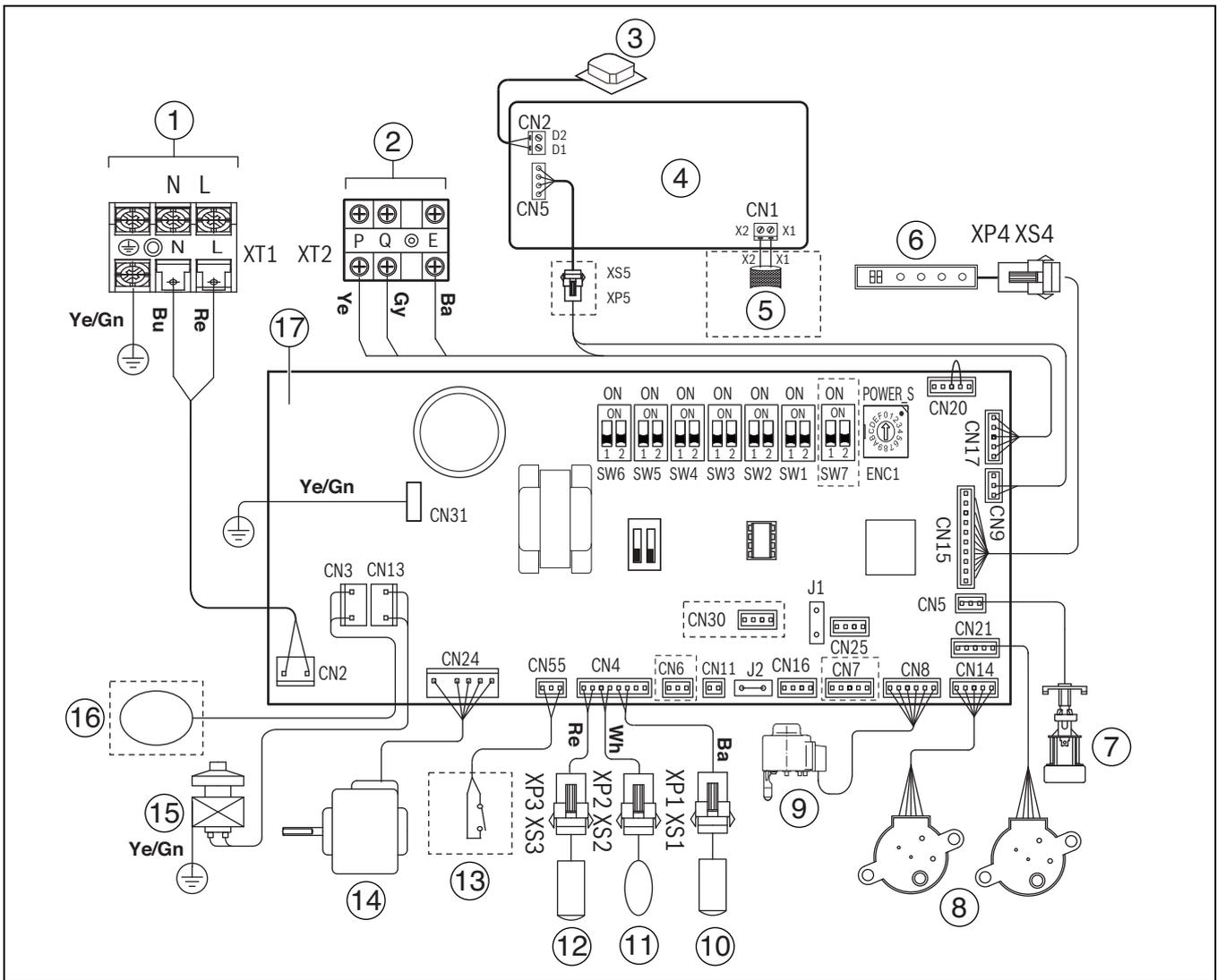
Рис. 55 Электропроводка, прототип 45–71
