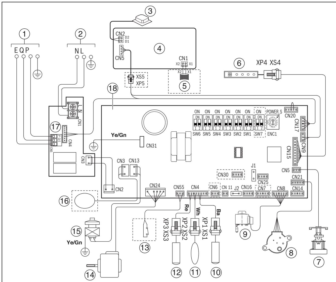
Рис. 54 Электропроводка, прототип 18–36
