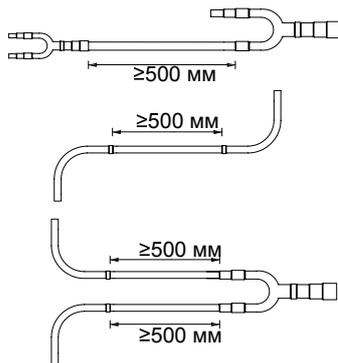
При наличии нескольких наружных блоков разветвители должны располагаться выше трубопровода хладагента (см.рис.ниже).
