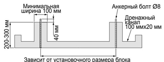
Для крепления установки следует использовать четыре анкерных болта М8. Рекомендуется вкручивать фундаментный болт до тех пор, пока он не будет утоплен в поверхность основания как минимум на 3 витка резьбы.
