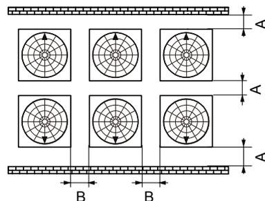
Монтаж блоков со стенами в трех направлениях:
