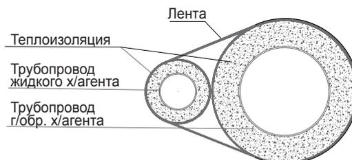
При обмотке теплоизоляционной лентой каждый виток должен прижимать половину предыдущего витка ленты. Не следует слишком плотно наматывать ленту, чтобы не снизить эффективность теплоизоляции.
