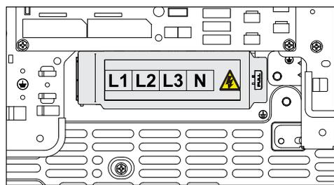
7. После подключения линии связи и кабеля электропитания закрыть металлический лист крышки электрического блока управления и плотно связать проводку через кольцо с помощью стягивающей ленты.
