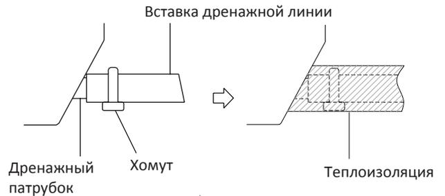
2. При удлинении дренажной трубы надежно закрепите и заизолируйте место соединения, не допускайте того, чтобы дренажная труба болталась.
