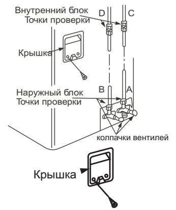
Электрическая схема расположена на внутренней стороне крышки
