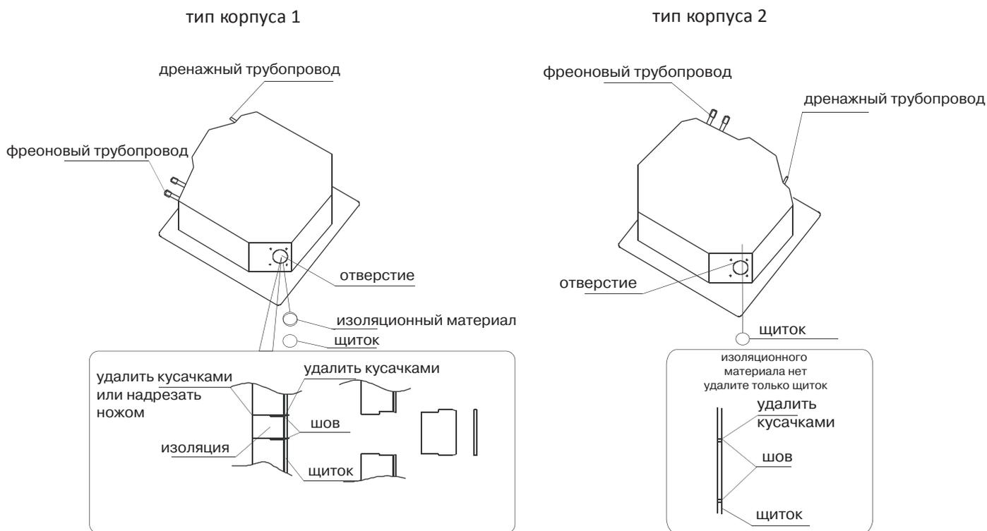
3. Установите на корпус (приклейте) изоляционный материал:
