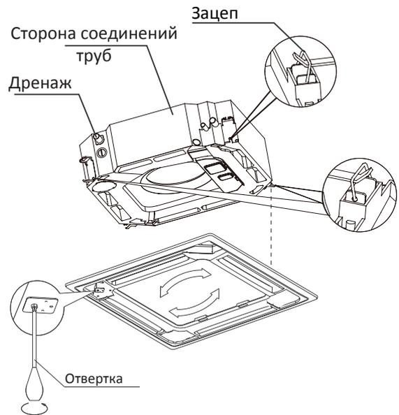
После установки панели убедитесь, что между корпусом блока и декоративной панелью нет свободного пространства. В противном случае воздух может просочиться через зазор и вызвать появление конденсата. (См. Рисунок ниже)
