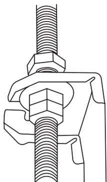
**ПРИМЕЧАНИЕ.** Нижняя часть блока должна быть на 24 мм выше потолочной панели. Как правило, длина L должна быть достаточной для размещения гаек.
