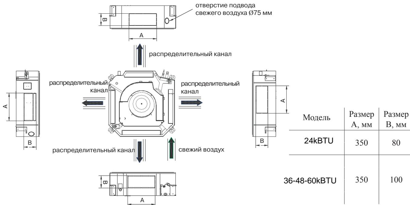
Для распределения потоков воздуха в разные части помещения (или отвода части потока в соседнее помещение) выполните следующие операции:
