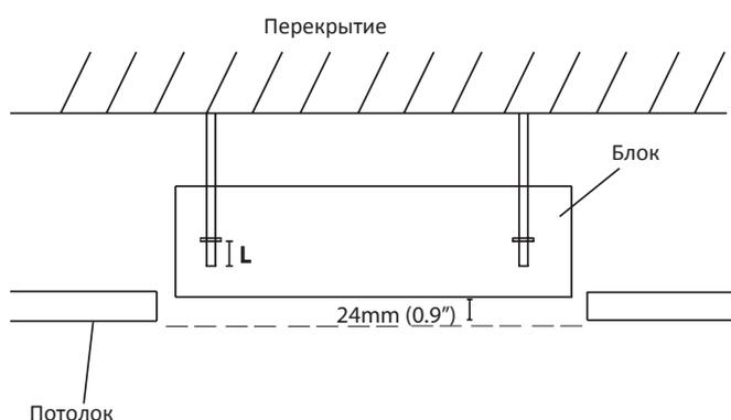
**ПРИМЕЧАНИЕ.** Убедитесь, что блок выровнен. Блок оснащен встроенным дренажным насосом и датчиком уровня. Если блок наклонён против направления потоков конденсата (сторона дренажной трубы поднята), датчик может работать со сбоями и может появиться утечка конденсата.
