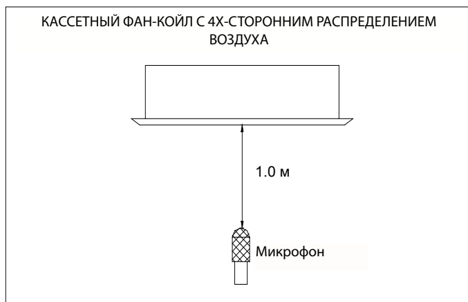
Рисунок №6 Схема испытаний шумовых характеристик агрегатов
