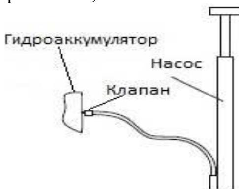
Давление в гидроаккумуляторе не должно превышать 1,6 бар, рекомендуемое давление – 1,4-1,6 бар. Для проверки давления подключите манометр к клапану гидроаккумулятора, как показано на рисунке ниже.
